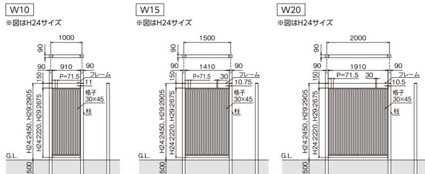
●ブロック上への施工はできません。柱は、独立基礎で埋込み施工してください。
