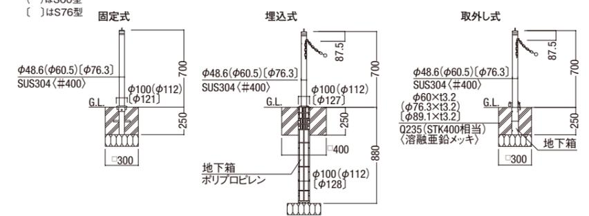
●S114型・S165型寸法図(単位mm)
