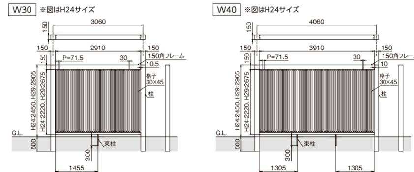
●ブロック上への施工はできません。柱は、独立基礎で埋込み施工してください。
