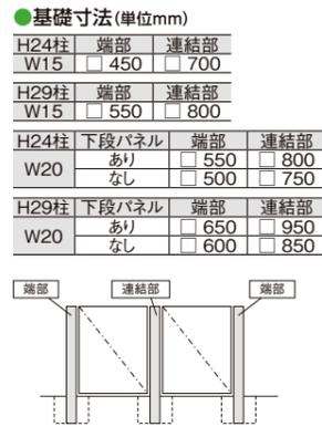
●ブロック上への施工はできません。柱は、独立基礎で埋込み施工してください。●現場切り詰めはできません。特注にて対応ください。
