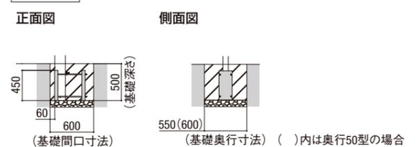
※図の基礎寸法は長期地耐力100kN/m<sup>2</sup>相当(側面地耐力も100kN/m<sup>2</sup>)の場合です。地盤の条件により基礎サイズが変わるため、P.79も合わせてご覧ください。
