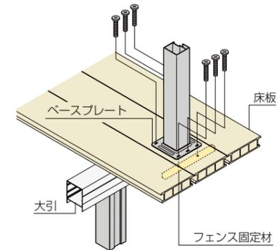
ベースプレート(床板固定用セット)には、「フェンス固定材」が2本同梱されています。ベースプレートの下に大引がない場合は「フェンス固定材」を2本使用します。
