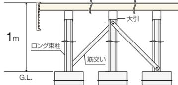
ロング束柱(L=879mm)を使うと高台や傾斜面への施工に対応できます(切り詰め加工も可能)。
