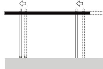
※屋根長さ切詰めによって柱位置が移動する場合は、雨樋穴ふさぎキャップセット、穴ふさぎシールセットを必要な柱分拾い出してください。
