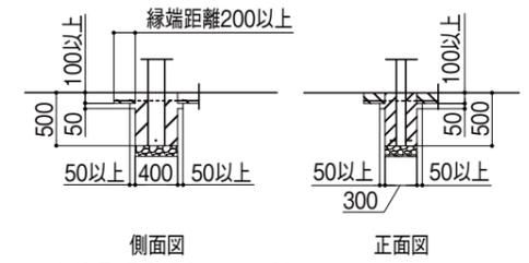
※基礎寸法図は長期耐力100kN/m<sup>2</sup>相当(側面耐力も100kN/m<sup>2</sup>)の場合です。
