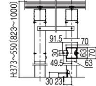
出幅方向納まり図(側面)標準束柱
