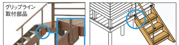
SH樹ら楽ステージ 木彫ステップに「グリップライン(手すり)」が取り付けられる専用部品です。スムーズで安全な昇降に役立ちます。ステップ3段、4段のみ取り付けできます。
