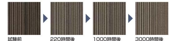
サンシャインウェザーメーターによる耐候促進試験の結果 ※300時間を屋外暴露1年の目安としています。(デッキ使用の基準)
