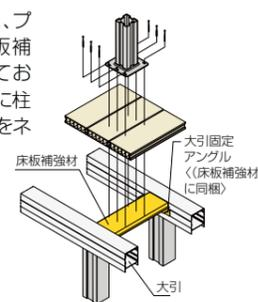
フェンスのベースプレートは「ベースプレート(床板補強材固定用セット)」を選択し、床板補強材と併せて使用してください。
