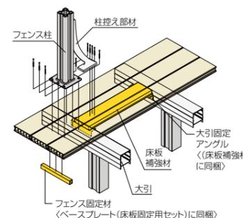
ベースプレート(床板固定用セット)には、「フェンス固定材」が2本同梱されています。ベースプレートの下に大引が無い場合は「フェンス固定材」を2本使用します。
