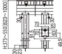
出幅方向納まり図(側面)束柱A・幕板使用
