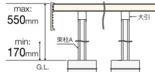
デッキの床高を最大550mmから最小170mmの範囲で調整することができます(束柱を切り詰め加工)。
