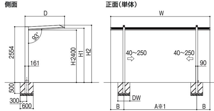
※本図は標準柱(H24)を示します。ロング柱(H30)は標準柱(H24)+600mm。
