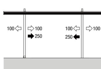
※柱を内側に101mm以上移動させる場合、両側の柱を均等に移動させてください。商品やサイズにより対応可否がありますので、寸法図をご確認ください。
