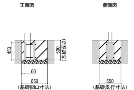
※図の基礎寸法は長期地耐力100kN/m<sup>2</sup>相当(側面地耐力も100kN/m<sup>2</sup>)の場合です。地盤の条件により基礎サイズが変わるため、P.93も合わせてご覧ください。
