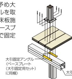
「大引固定アングル」はフェンスの「ベースプレート(大引固定用セット)」に2個同梱されています。
