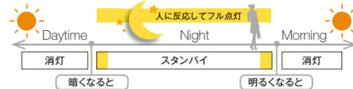
暗くなると照明が30秒間自動点灯します。その後、スタンバイ中に人を感知すると「フル点灯」し、検知範囲に人がいなくなつてから30秒間点灯した後に消灯します。(注:連続点灯への切替はできません)
